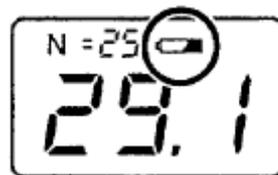
9、出现此图示，说明仪器工作不正常，将开关打到关，然后再打开，如果仍出现此图示，说明仪器坏了，需要修理。
